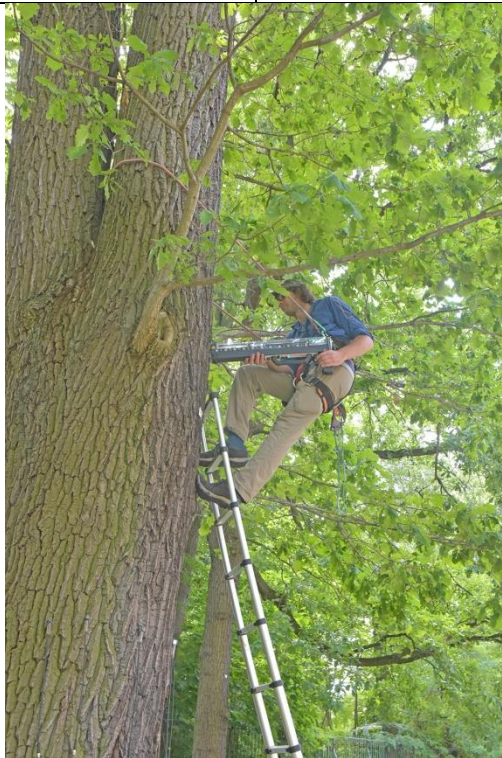
Fot. 6.11. Dąb szypułkowy nr inw. 6, Zespół Szkół nr 3 im. Mikołaja Reja w Kędzierzynie-Koźlu. W trakcie badania rezystografem na wysokości 395 cm powyżej ubytku – odpowiednik miejsca między czujnikami nr 3 i 4.
