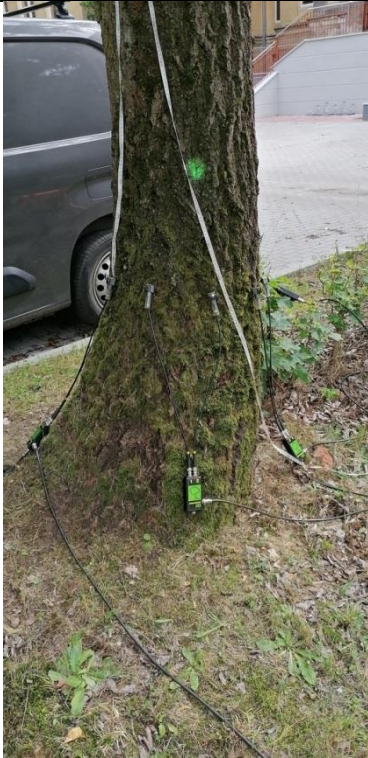
Fot. 39.5. Topola szara nr inw. 177, Zespół Szkół nr 3 im. Mikołaja Reja w Kędzierzynie-Koźlu. W trakcie badania tomografem sonicznym na wys. 55cm.
