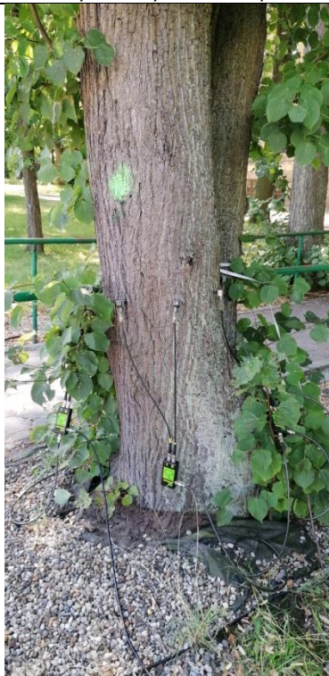
Fot. 21.7 i 21.8. Lipa europejska nr inw. 100, Zespół Szkół nr 3 im. Mikołaja Reja w Kędzierzynie-Koźlu. W trakcie badania tomografem sonicznym na wys. 85cm na pniu od strony N.
