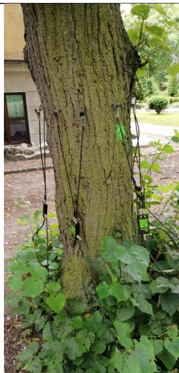
Fot. 31.6. Lipa holenderska nr inw. 138, Zespół Szkół nr 3 im. Mikołaja Reja w Kędzierzynie-Koźlu. W trakcie badania tomografem sonicznym na wys. 135cm.
