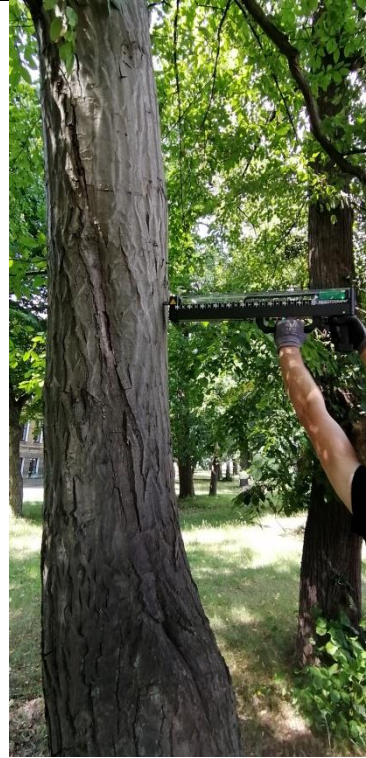
Fot. 18.5. Grab pospolity nr inw. 78, Zespół Szkół nr 3 im. Mikołaja Reja w Kędzierzynie-Koźlu. W trakcie badania rezystografem na wysokości 225 cm od strony N.
