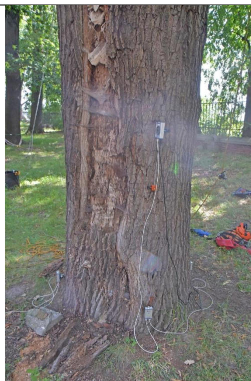
Fot. 6.15. Dąb szypułkowy nr inw. 6, Zespół Szkół nr 3 im. Mikołaja Reja w Kędzierzynie-Koźlu. Próba obciążeniowa - miejsce mocowania czujników - strona rozciągnana
