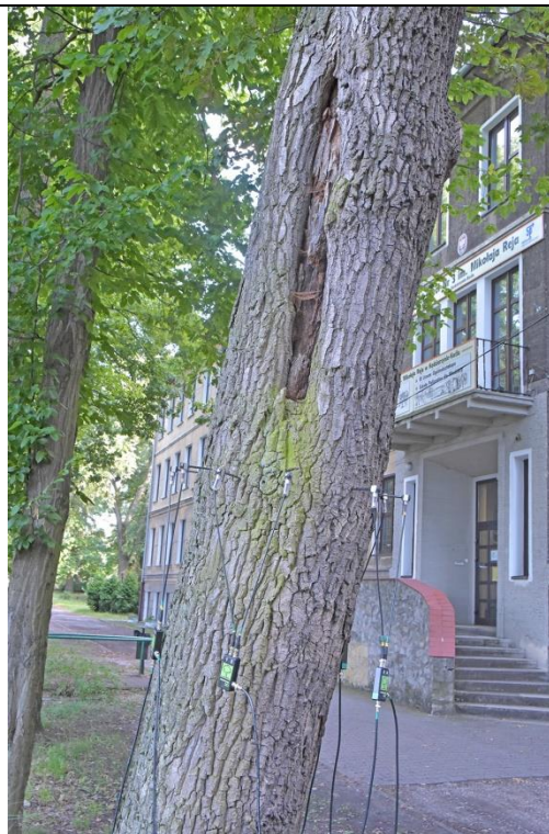
Fot. 26.6. Dąb szypułkowy nr inw. 108, Zespół Szkół nr 3 im. Mikołaja Reja w Kędzierzynie-Koźlu. W trakcie badania tomografem sonicznym na wys. 203cm.
