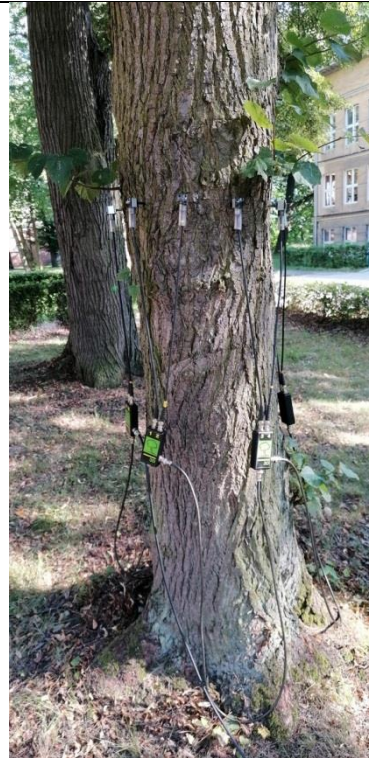
Fot. 38.6. Lipa holenderska nr inw. 176, Zespół Szkół nr 3 im. Mikołaja Reja w Kędzierzynie-Koźlu. W trakcie badania tomografem sonicznym na wys. 145 cm.
