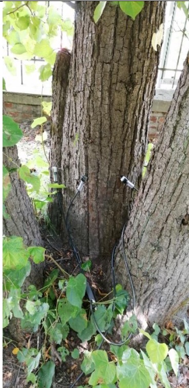
Fot. 20.11. Lipa holenderska nr inw. 92, Zespół Szkół nr 3 im. Mikołaja Reja w Kędzierzynie-Koźlu. W trakcie badania tomografem sonicznym na wys. 37 cm na pniu nr 2.
