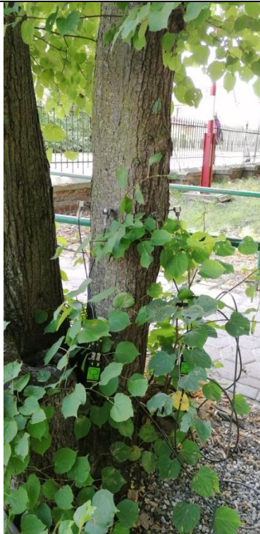
Fot. 21.5. Lipa europejska nr inw. 100, Zespół Szkół nr 3 im. Mikołaja Reja w Kędzierzynie-Koźlu. W trakcie badania tomografem sonicznym na wys. 92cm na pniu od strony S.
