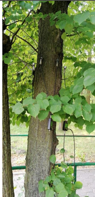
Fot. 21.6. Lipa europejska nr inw. 100, Zespół Szkół nr 3 im. Mikołaja Reja w Kędzierzynie-Koźlu. W trakcie badania tomografem sonicznym na wys. 197cm na pniu od strony S.
