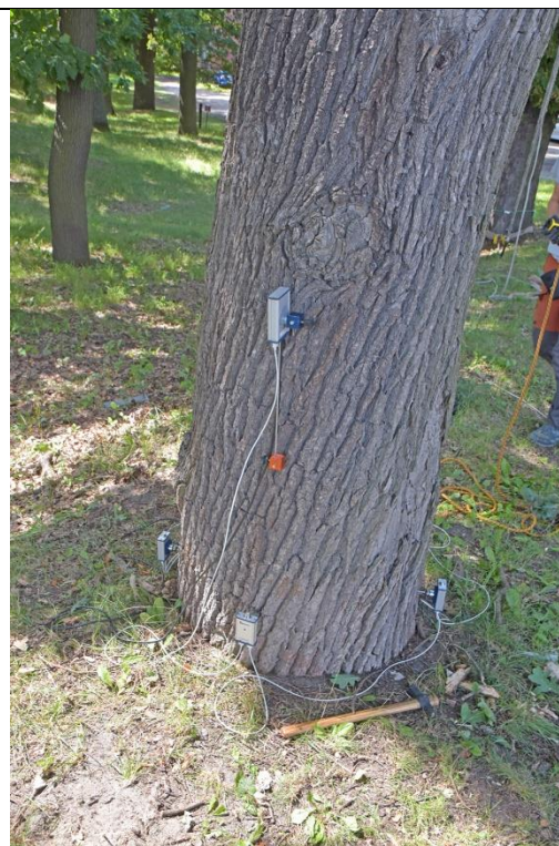
Fot. 9.12. Dąb szypułkowy nr inw. 16, Zespół Szkół nr 3 im. Mikołaja Reja w Kędzierzynie-Koźlu. Próba obciążeniowa - miejsce mocowania czujników – strona rozciągana.
