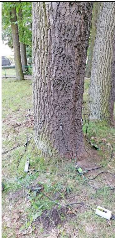
Fot. 26.5. Dąb szypułkowy nr inw. 108, Zespół Szkół nr 3 im. Mikołaja Reja w Kędzierzynie-Koźlu. W trakcie badania tomografem sonicznym na wys. 55cm.
