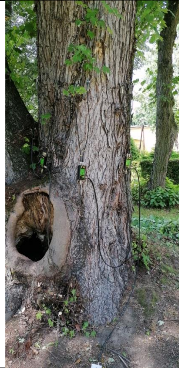
Fot. 12.12. Klon srebrzysty nr inw. 62, Zespół Szkół nr 3 im. Mikołaja Reja w Kędzierzynie-Koźlu. W trakcie badania tomografem sonicznym na wysokości 165cm na pniu nr 2.
