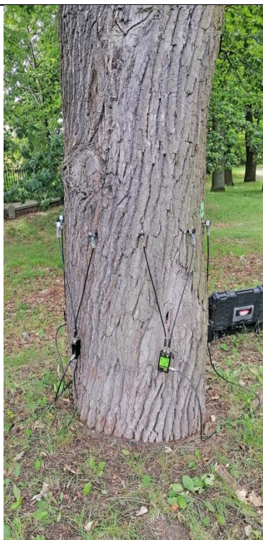
Fot. 9.9 i 9.10. Dąb szypułkowy nr inw. 16, Zespół Szkół nr 3 im. Mikołaja Reja w Kędzierzynie-Koźlu. W trakcie badania tomografem sonicznym na wysokości 110 cm.
