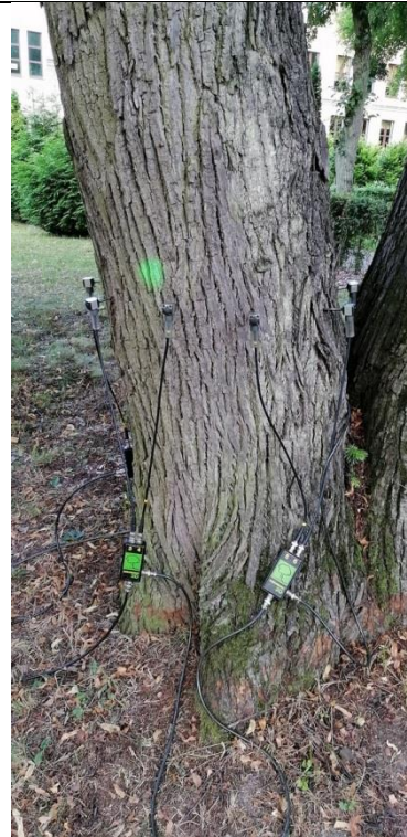
Fot. 37. 12. Lipa holenderska nr inw. 175, Zespół Szkół nr 3 im. Mikołaja Reja w Kędzierzynie-Koźlu. Pień I. W trakcie badania tomografem sonicznym na wys. 180 cm.
