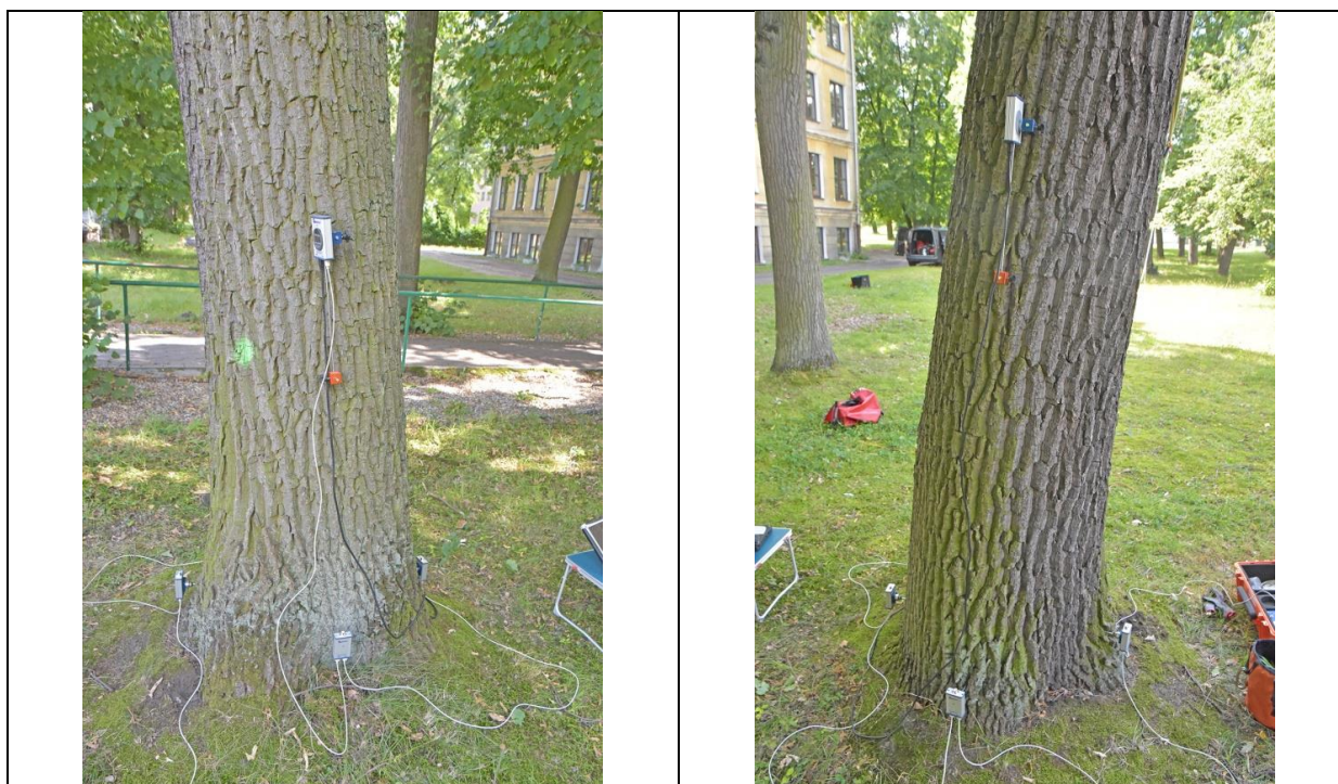
Fot. 22.9. Dąb szypułkowy nr inw. 101, Zespół Szkół nr 3 im. Mikołaja Reja w Kędzierzynie-Koźlu. Próba obciążeniowa – miejsce mocowania czujników – strona ściskana.
