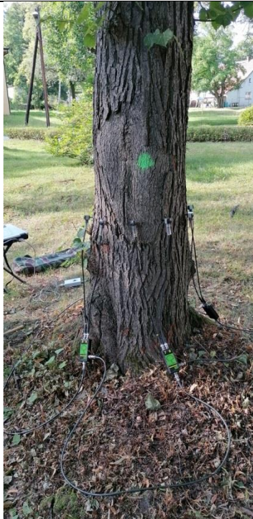
Fot. 38.5. Lipa holenderska nr inw. 176, Zespół Szkół nr 3 im. Mikołaja Reja w Kędzierzynie-Koźlu. W trakcie badania tomografem sonicznym na wys. 75 cm.
