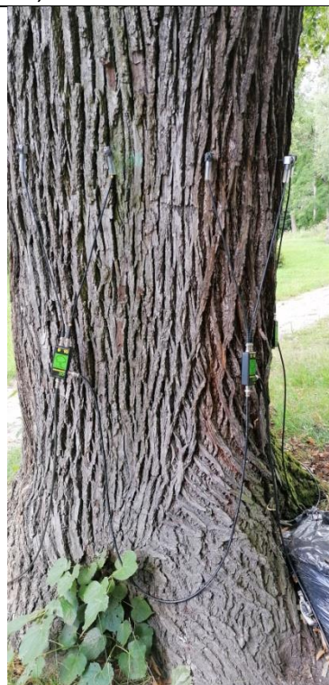
Fot. 32.6. Lipa holenderska nr inw. 139, Zespół Szkół nr 3 im. Mikołaja Reja w Kędzierzynie-Koźlu. W trakcie badania tomografem sonicznym na wys. 145cm.
