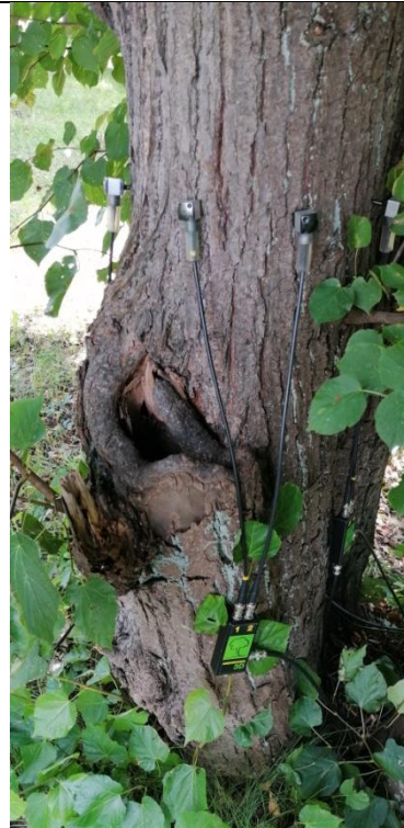
Fot. 20.12. Lipa holenderska nr inw. 92, Zespół Szkół nr 3 im. Mikołaja Reja w Kędzierzynie-Koźlu. W trakcie badania tomografem sonicznym na wys. 110 cm na pniu nr 2.
