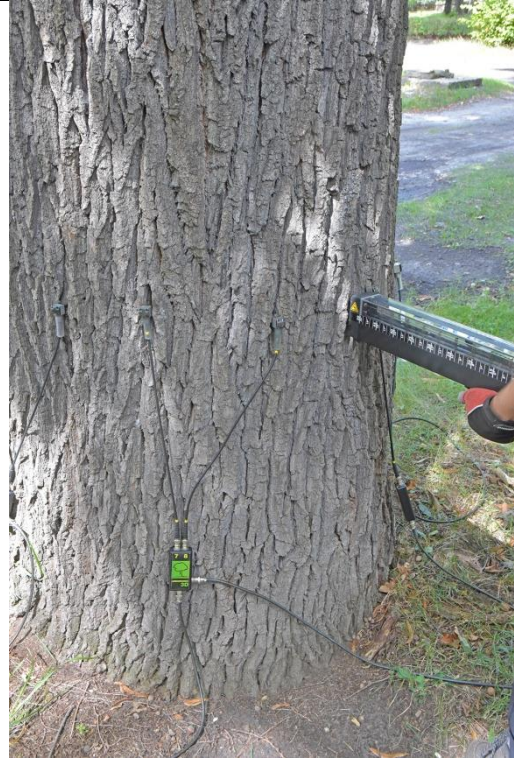
Fot. 6.10. Dąb szypułkowy nr inw. 6, Zespół Szkół nr 3 im. Mikołaja Reja w Kędzierzynie-Koźlu. W trakcie badania rezystografem na wys. 78 cm między czujnikami nr 8 i 9.
