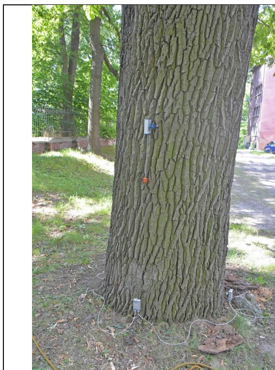
Fot. 6.14. Dąb szypułkowy nr inw. 6, Zespół Szkół nr 3 im. Mikołaja Reja w Kędzierzynie-Koźlu. Próba obciążeniowa - miejsce mocowania czujników - strona ścisana
