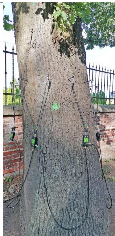
Fot. 15.10. Dąb szypułkowy nr inw. 71, Zespół Szkół nr 3 im. Mikołaja Reja w Kędzierzynie-Koźlu. W trakcie badania tomografem sonicznym na wysokości 145 cm.
