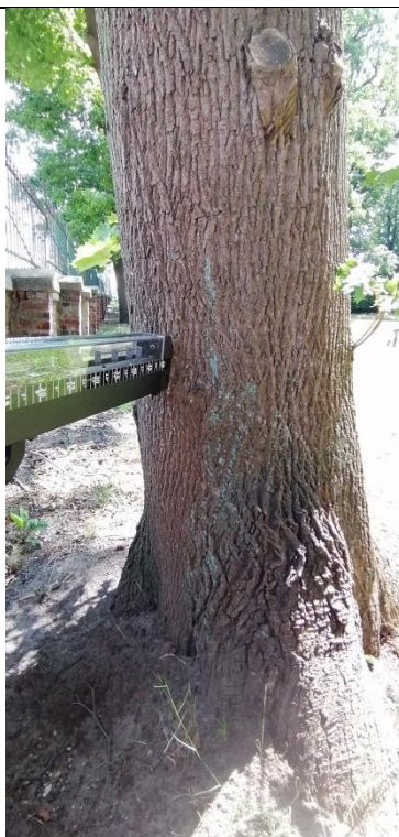
Fot. 17.5. Klon pospolity nr inw. 75, Zespół Szkół nr 3 im. Mikołaja Reja w Kędzierzynie-Koźlu. W trakcie badania rezystografem na wysokości 70cm od strony N.
