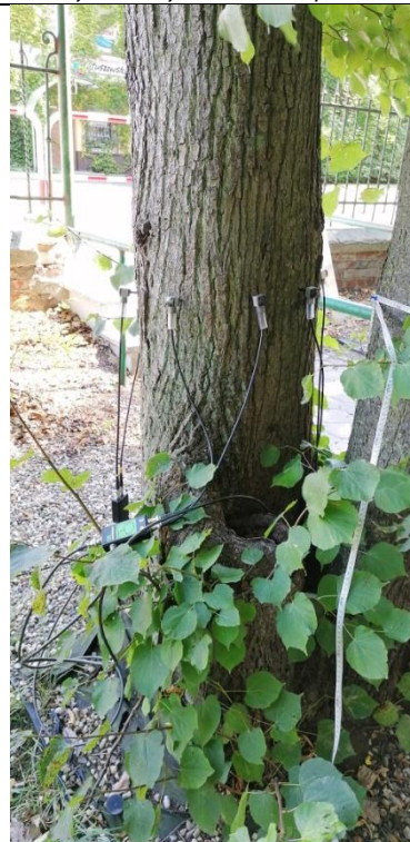
Fot. 21.7 i 21.8. Lipa europejska nr inw. 100, Zespół Szkół nr 3 im. Mikołaja Reja w Kędzierzynie-Koźlu. W trakcie badania tomografem sonicznym na wys. 85cm na pniu od strony N.
