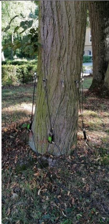
Fot. 36.5. Lipa holenderska 174, Zespół Szkół nr 3 im. Mikołaja Reja w Kędzierzynie-Koźlu. W trakcie badania tomografem sonicznym na wys. 85cm.
