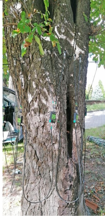
Fot. 8.8. Kasztanowiec pospolity nr inw 15, Zespół Szkół nr 3 im. Mikołaja Reja w Kędzierzynie-Koźlu. W trakcie badania tomografem sonicznym na wysokości 168 cm.
