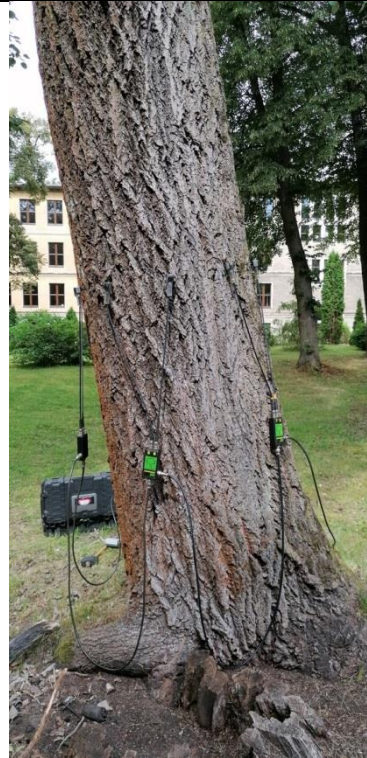
Fot. 40.6. Topola szara nr inw. 178, Zespół Szkół nr 3 im. Mikołaja Reja w Kędzierzynie-Koźlu. W trakcie badania tomografem sonicznym na wys. 130 cm.
