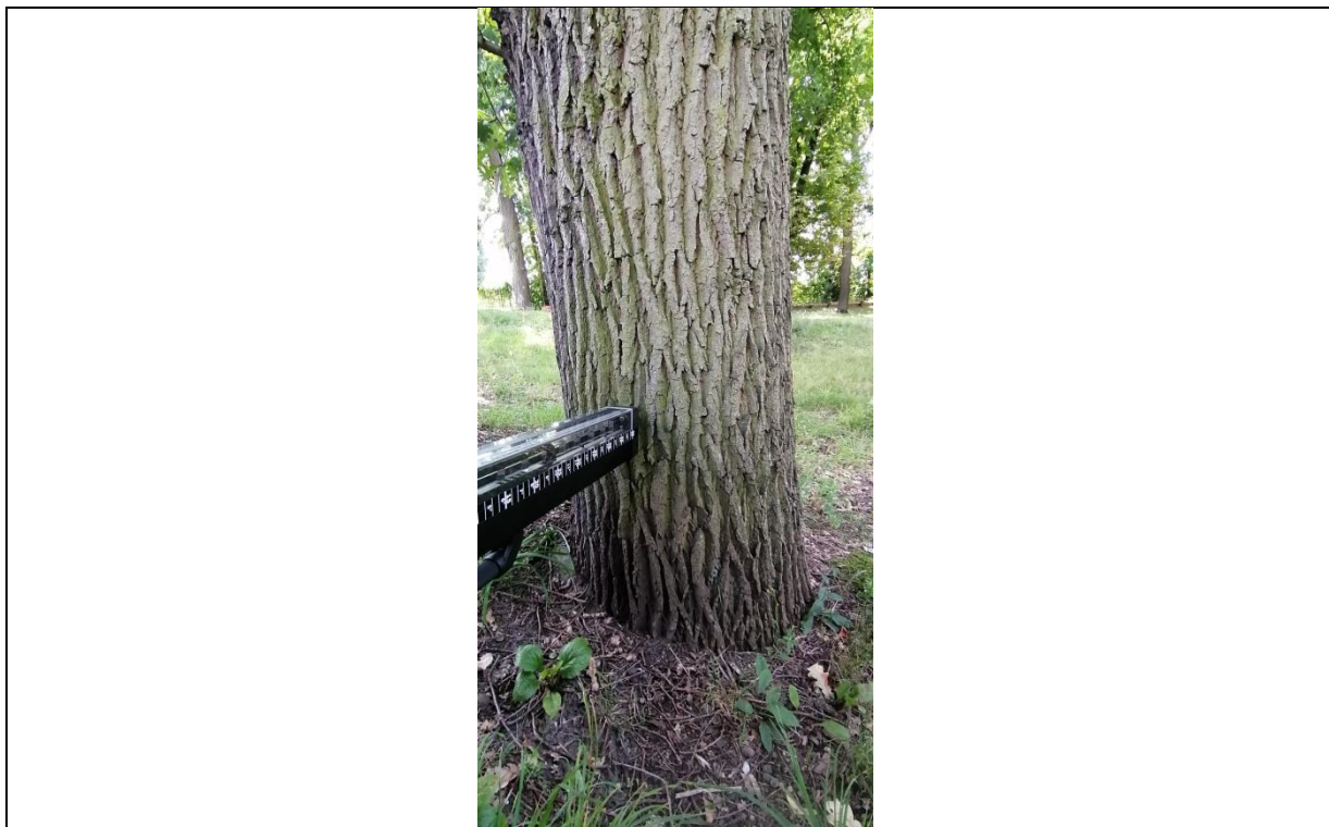
Fot. 14.5. Dąb szypułkowy nr inw. 68, Zespół Szkół nr 3 im. Mikołaja Reja w Kędzierzynie-Koźlu. W trakcie badania rezystografem na wysokości 50 cm od strony N.
