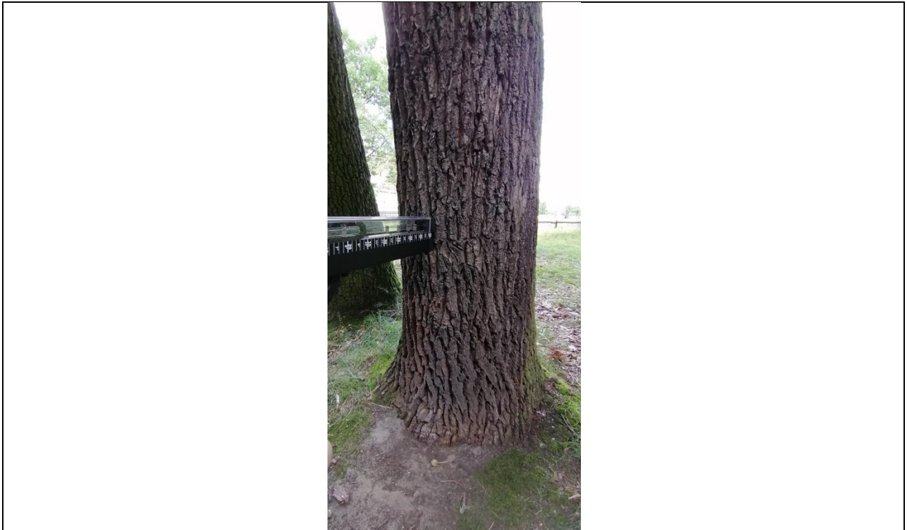
Fot. 27.5. Dąb szypułkowy nr inw. 109, Zespół Szkół nr 3 im. Mikołaja Reja w Kędzierzynie-Koźlu. W trakcie badania rezystografem na wys. 75cm.
