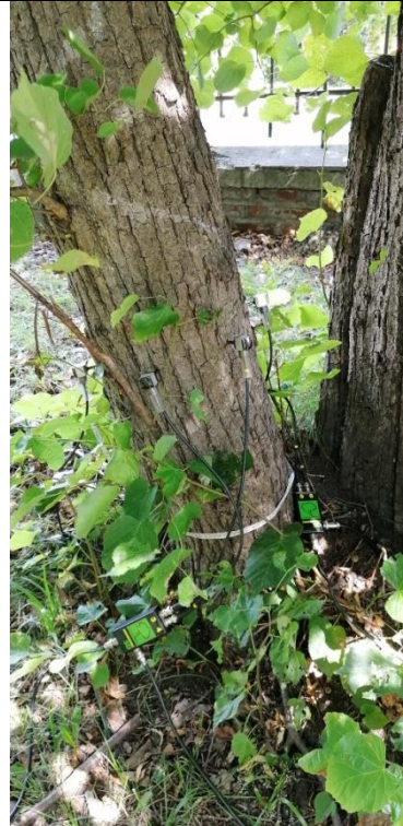
Fot. 20.10. Lipa holenderska nr inw. 92, Zespół Szkół nr 3 im. Mikołaja Reja w Kędzierzynie-Koźlu. W trakcie badania tomografem sonicznym na wys. 45 cm na pniu nr1.
