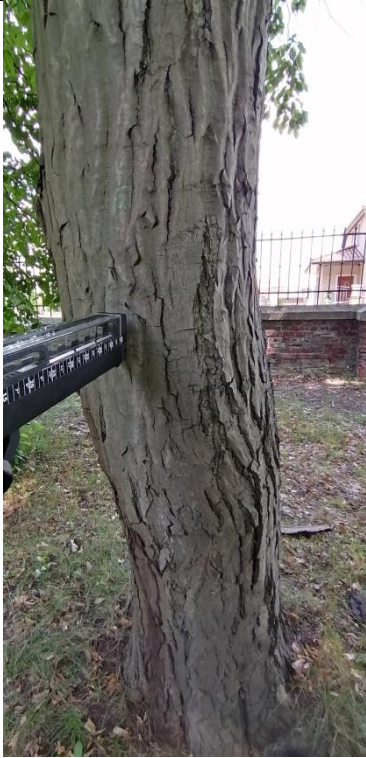
Fot. 18.5. Grab pospolity nr inw. 78, Zespół Szkół nr 3 im. Mikołaja Reja w Kędzierzynie-Koźlu. W trakcie badania rezystografem na wysokości 135 cm od strony S.
