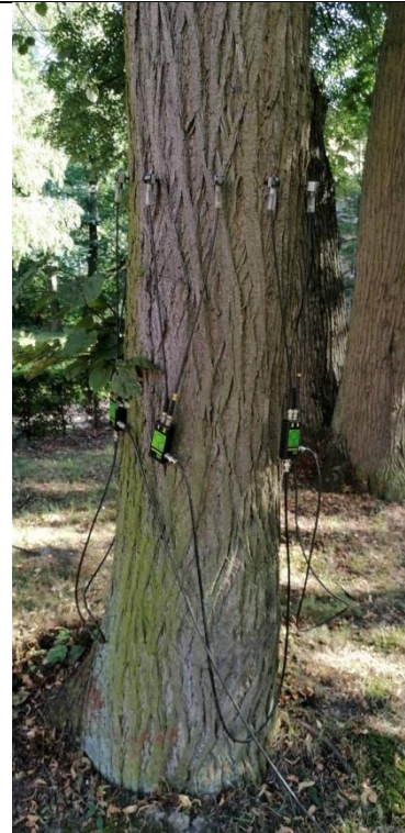
Fot. 36.6. Lipa holenderska 174, Zespół Szkół nr 3 im. Mikołaja Reja w Kędzierzynie-Koźlu. W trakcie badania tomografem sonicznym na wys. 163cm.
