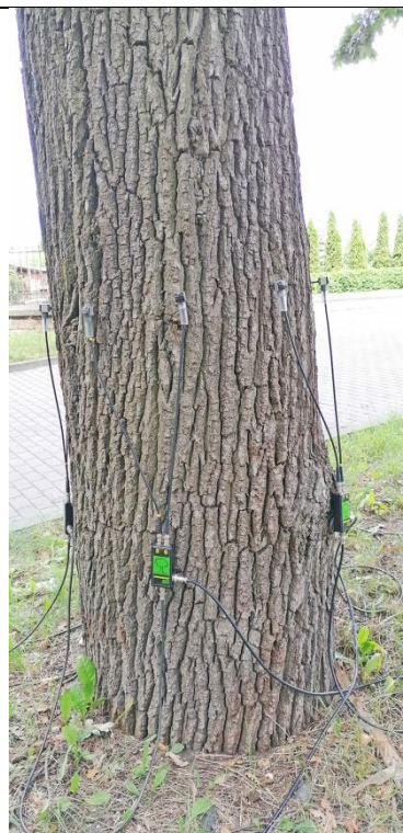
Fot. 9.9 i 9.10. Dąb szypułkowy nr inw. 16, Zespół Szkół nr 3 im. Mikołaja Reja w Kędzierzynie-Koźlu. W trakcie badania tomografem sonicznym na wysokości 110 cm.
