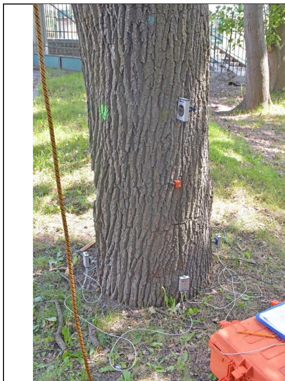
Fot. 9.11. Dąb szypułkowy nr inw. 16, Zespół Szkół nr 3 im. Mikołaja Reja w Kędzierzynie-Koźlu. Próba obciążeniowa - miejsce mocowania czujników - strona ściskana.
