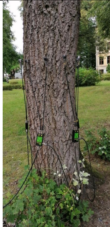
Fot. 39.6. Topola szara nr inw. 177, Zespół Szkół nr 3 im. Mikołaja Reja w Kędzierzynie-Koźlu. W trakcie badania tomografem sonicznym na wys. 150cm.
