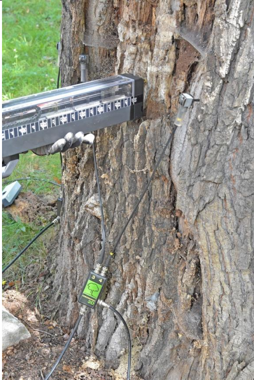
Fot. 6.9. Dąb szypułkowy nr inw. 6, Zespół Szkół nr 3 im. Mikołaja Reja w Kędzierzynie-Koźlu. W trakcie badania rezystografem na wys. 78 cm między czujnikami nr 3 i 4.
