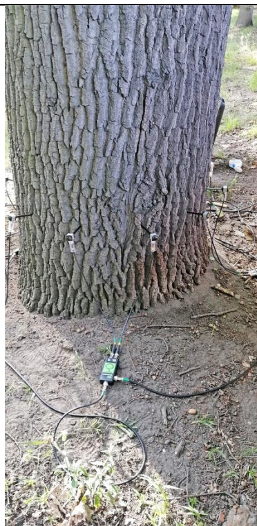
Fot. 15.9. Dąb szypułkowy nr inw. 71, Zespół Szkół nr 3 im. Mikołaja Reja w Kędzierzynie-Koźlu. W trakcie badania tomografem sonicznym na wysokości 45 cm.
