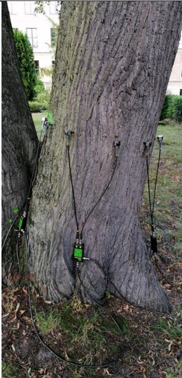
Fot. 37.13. Lipa holenderska nr inw. 175, Zespół Szkół nr 3 im. Mikołaja Reja w Kędzierzynie-Koźlu. Pień II. W trakcie badania tomografem sonicznym na wys. 85cm.
