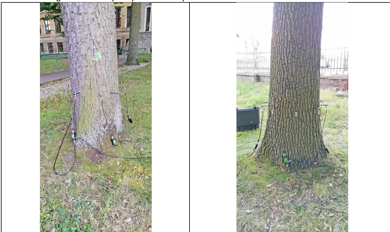
Fot. 22.7 i 22.8. Dąb szypułkowy nr inw. 101, Zespół Szkół nr 3 im. Mikołaja Reja w Kędzierzynie-Koźlu. W trakcie badania tomografem sonicznym na wys. 70cm.
