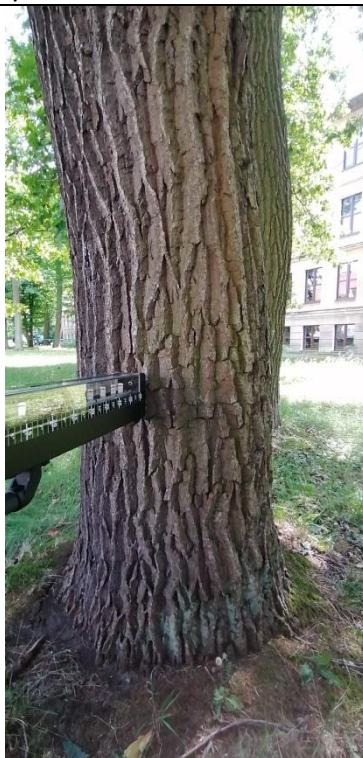
Fot. 28.5. Dąb szypułkowy nr inw. 119, Zespół Szkół nr 3 im. Mikołaja Reja w Kędzierzynie-Koźlu. W trakcie badania rezystografem na wys. 62 cm.
