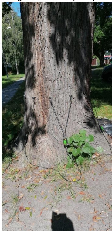
Fot. 32.5. Lipa holenderska nr inw. 139, Zespół Szkół nr 3 im. Mikołaja Reja w Kędzierzynie-Koźlu. W trakcie badania tomografem sonicznym na wys. 80cm.
