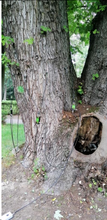
Fot. 12.11. Klon srebrzysty nr inw. 62, Zespół Szkół nr 3 im. Mikołaja Reja w Kędzierzynie-Koźlu. W trakcie badania tomografem sonicznym na wysokości 150cm na pniu nr 1.
