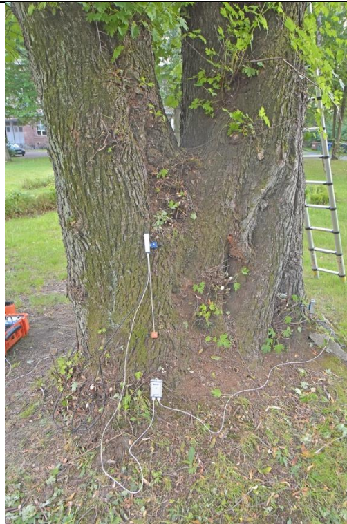
Fot. 12.14. Klon srebrzysty nr inw. 62, Zespół Szkół nr 3 im. Mikołaja Reja w Kędzierzynie-Koźlu. Próba obciążeniowa - miejsce mocowania czujników – strona rozciągana.
