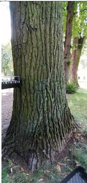
Fot. 30.4. Dąb szypułkowy nr inw. 134, Zespół Szkół nr 3 im. Mikołaja Reja w Kędzierzynie-Koźlu. W trakcie badania tomografem sonicznym na wys. 75 cm.
