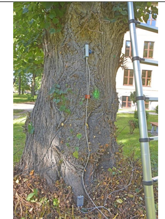
Fot. 35.8. Lipa holenderska nr inw. 173, Zespół Szkół nr 3 im. Mikołaja Reja w Kędzierzynie-Koźlu. Próba obciążeniowa – miejsce mocowania czujników – strona rozciągana.
