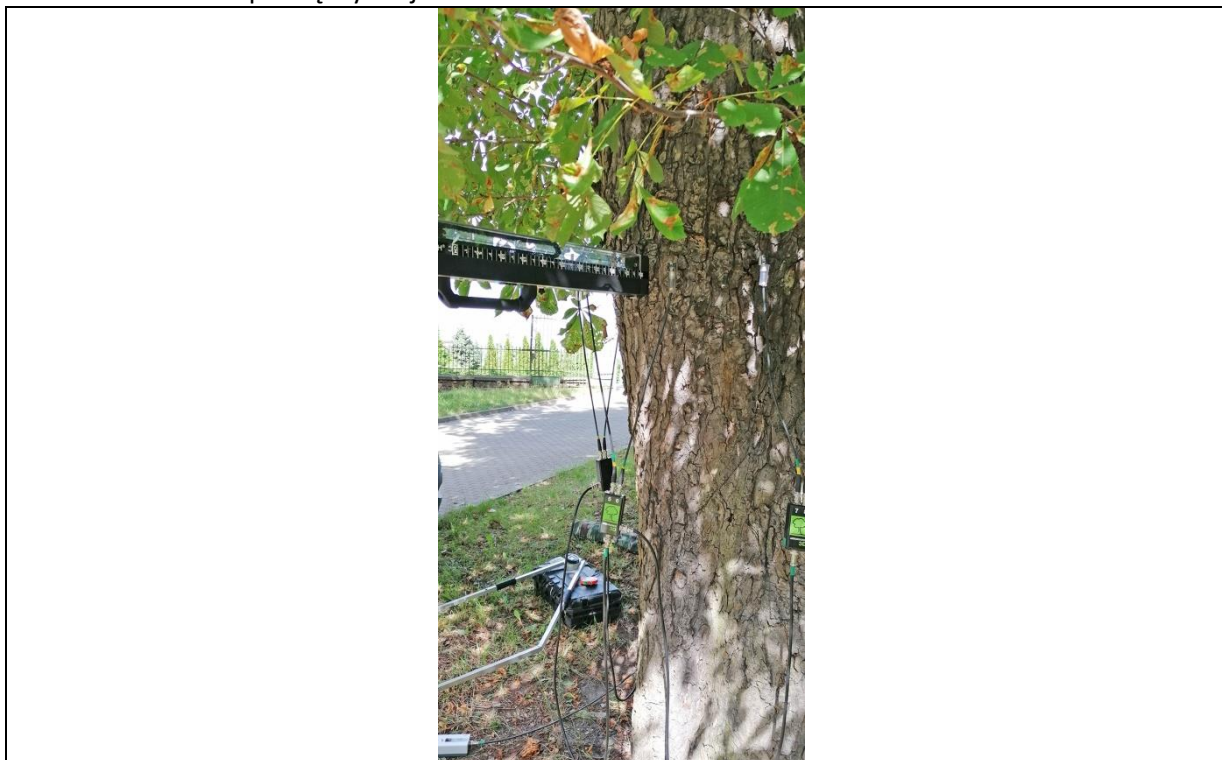
Fot. 8.9. Kasztanowiec pospolity nr inw 15, Zespół Szkół nr 3 im. Mikołaja Reja w Kędzierzynie-Koźlu. W trakcie badania rezystografem na wysokości 168cm między czujnikami nr 5 i 6.
