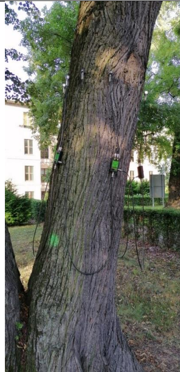
Fot. 37.14. Lipa holenderska nr inw. 175, Zespół Szkół nr 3 im. Mikołaja Reja w Kędzierzynie-Koźlu. Pień II. W trakcie badania tomografem sonicznym na wys. 210cm.
