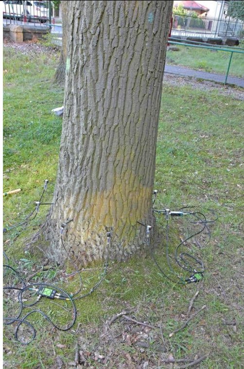
Fot. 23.5. Dąb szypułkowy nr inw. 102, Zespół Szkół nr 3 im. Mikołaja Reja w Kędzierzynie-Koźlu. W trakcie badania tomografem sonicznym na wys. 55cm.
